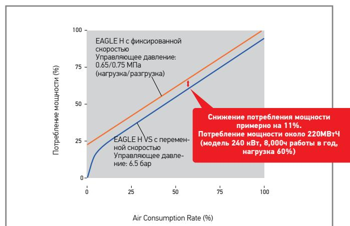
\* По сравнению с обычным типом управления нагрузки / разгрузки, установка низкого давления возможна благодаря стабильному контролю давления.
